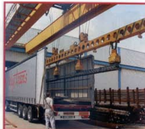
Przed rozładunkiem wystarczyło odsunięcie dachu i zdjęcie pasów mocujących. Stalowe pręty o łącznej wadze ponad 24 ton wyciągane są przez operatora suwnicy sposobem „na przysawkę”.
