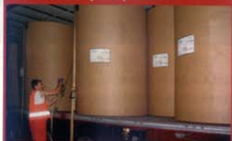
Ten ładunek waży mniej więcej tyle samo, co poprzedni, ale trochę urósł. Trzeba dokładnie zabezpieczyć role papieru o wysokości 210 mm pasami, bo punkt ciężkości zestawu drogowego drastycznie podskoczył.
